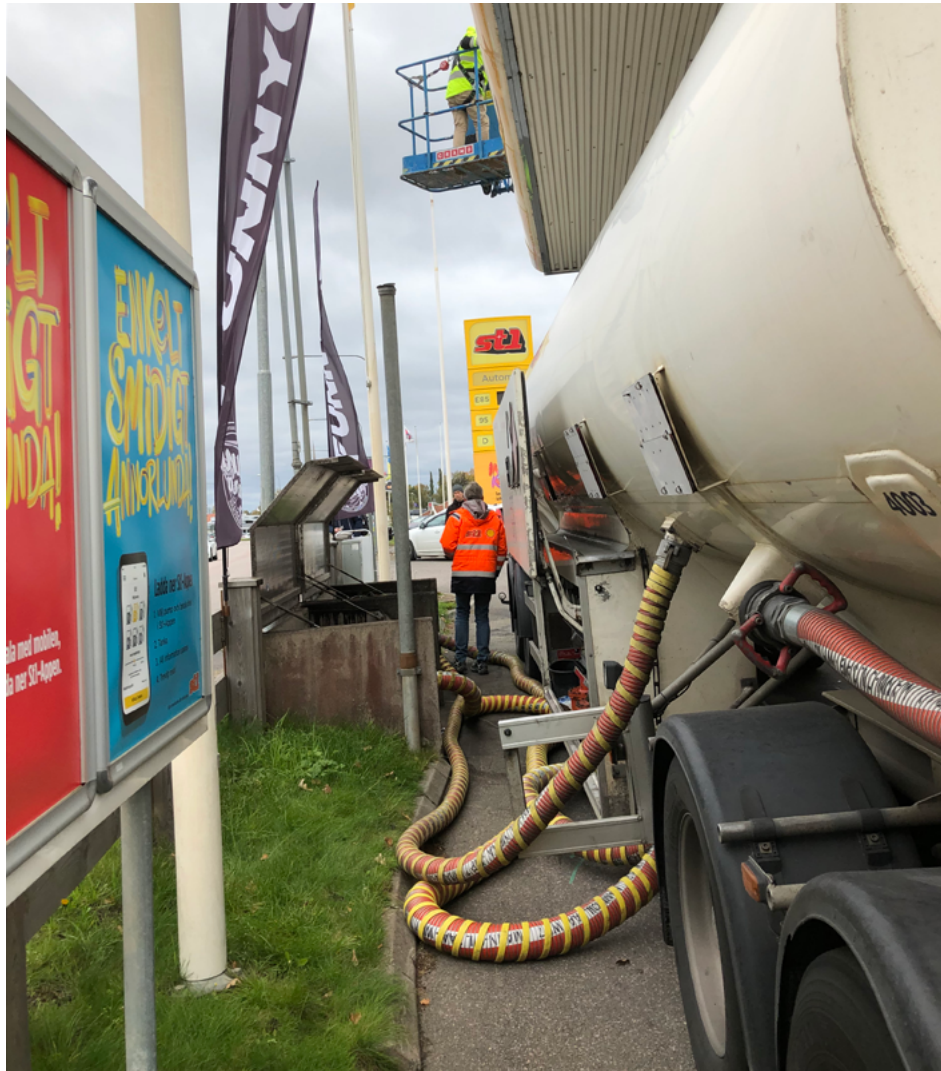
Exempel på lossning av drivmedel från tankbil. Foto: MSB.
