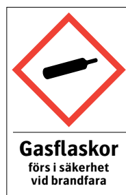
Figur 9. Varningsskylt för gas under tryck med tilläggs-texten ”Gasflaskor förs i säkerhet vid brandfara” 10
